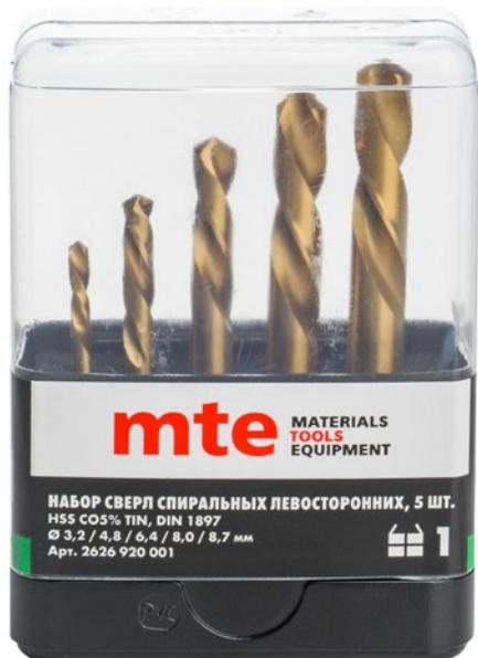
**Высококачественные левосторонние сверла с кобальтом и износостойким покрытием TiN для высверливания обломанных шпилек и болтов**
